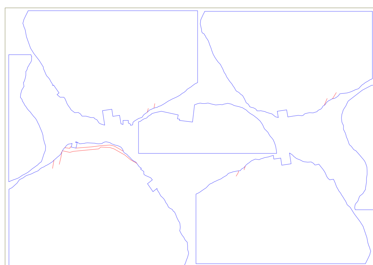
Höhenlinien mit _Join (Rhino) zu einer geschlossenen Kurve/Polylinie verbinden
