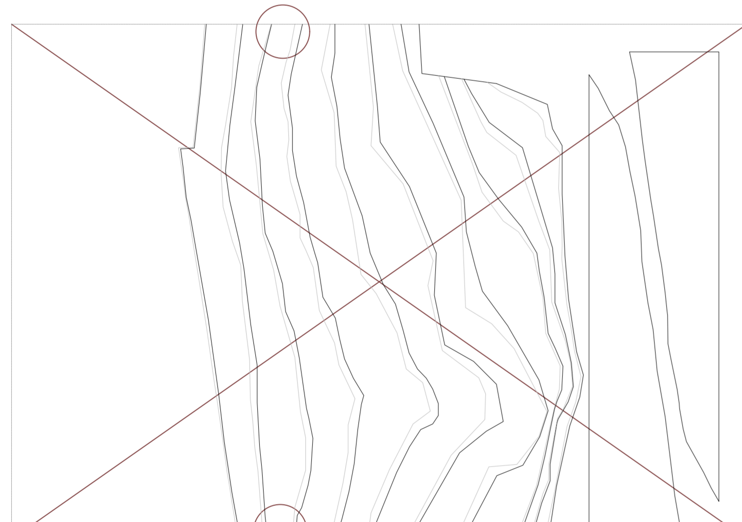
Die Zeichnung ist auf die gesamte Pappgröße (Standard: 700x1000mm) angelegt. Da die Platte aber nie genau so auf dem Laser/Schneidplotter positioniert werden kann oder es Abweichungen bei den Größen geben kann, werden mit dieser Methode die Teile nicht gleich groß.
