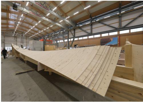
Herstellung des abgetreppten Überlappstoßes zwischen den einzelnen Bauteilen
