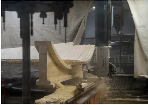
Vorfertigung von Verbindungsdetails in den BSP-Bauteilen
