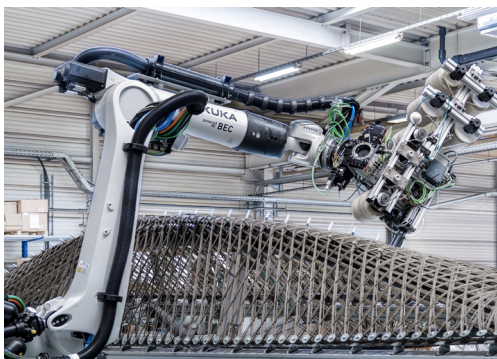
Roboter-Werkzeugeffektor: Faserwickelkopf mit Inline-Imprägnierung
